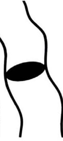
Abtastdiamant in der Plattenrinne
